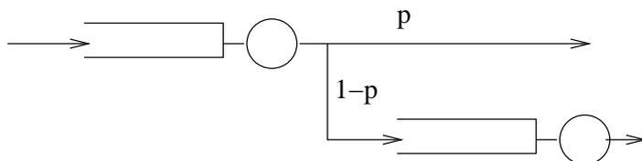
Kunden kommen in einem Poisson Prozess mit Rate 1.0 an der ersten Station an und werden dort nach FCFS bedient, wobei Bedienzeiten exponentiell mit Erwartungswert 0.7 verteilt sind. Nachdem ein Kunde Station 1 verlassen hat, verlässt er oder sie mit Wahrscheinlichkeit  $p$  das System oder geht mit Wahrscheinlichkeit  $1-p$  zu Station 2. Auch an Station 2 wird nach FCFS bedient, Bedienzeiten sind exponentiell verteilt mit Erwartungswert 0.9.
