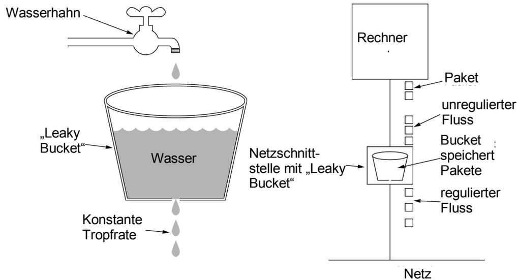
a) Skizzieren Sie eine mögliche Implementierung für den Leaky-Bucket-Algorithmus.
