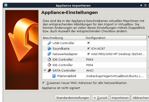
(c) Plattenabbild anpassen und Haken bei Zuweisen neuer MAC-Adressen für alle Netzwerkkarten setzen
