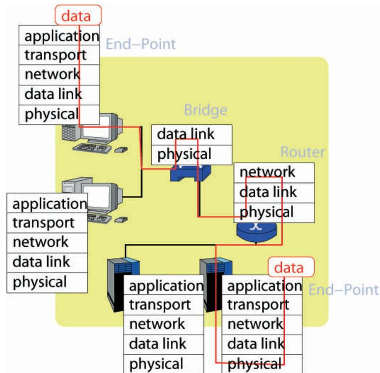
Erklären Sie das dargestellte Szenario. Was bedeutet der Unterschied zwischen Routern, Switches und Bridges für die Weiterleitung der Datenpakete?
