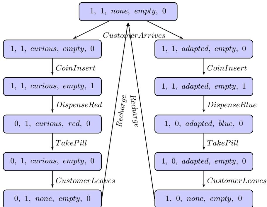
Beweisen Sie anschließend die beiden Eigenschaften mittels Induktion bzw. Liveness-Regeln. Der Münzautomat wurde vereinfacht: Jede Pille kostet nur noch eine Münze. Der vereinfachte Automat besitzt das gezeigte Zustandsdiagramm. Das STS des Automaten ist:
